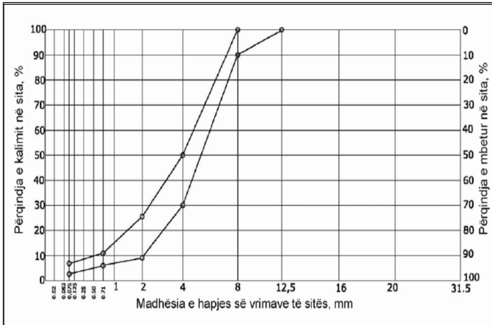
Figura 3.10: Kufinj të kompozimit të përzierjes së kokrrizave të gurit për shtresat sipërfaqësore të stabilizuara (ShSS) prej përzierjeve të asfaltit poroz AP 8 dhe AP 8S
